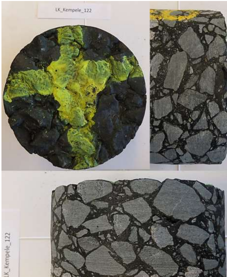
Kuva 28 Havainnekuva tiiviistä poranäytteestä, jossa ei ole nähtävissä reikiä tai koloja.
