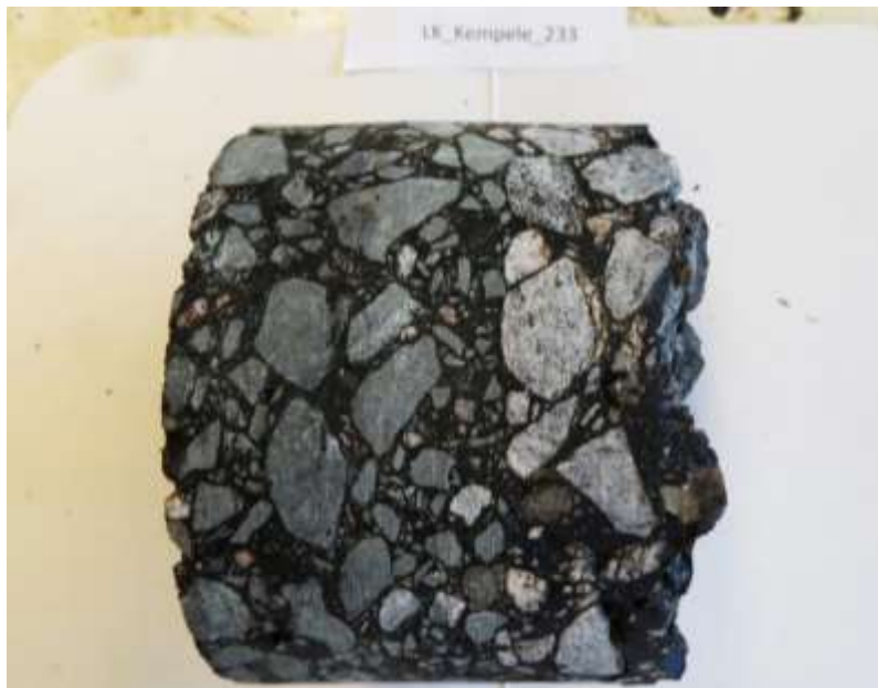
Kuva 31 Kuvassa on esitetty 2-kaistalle tyypillinen poranäyte, joka on silmämääräisesti tarkasteltuna tiivis.
