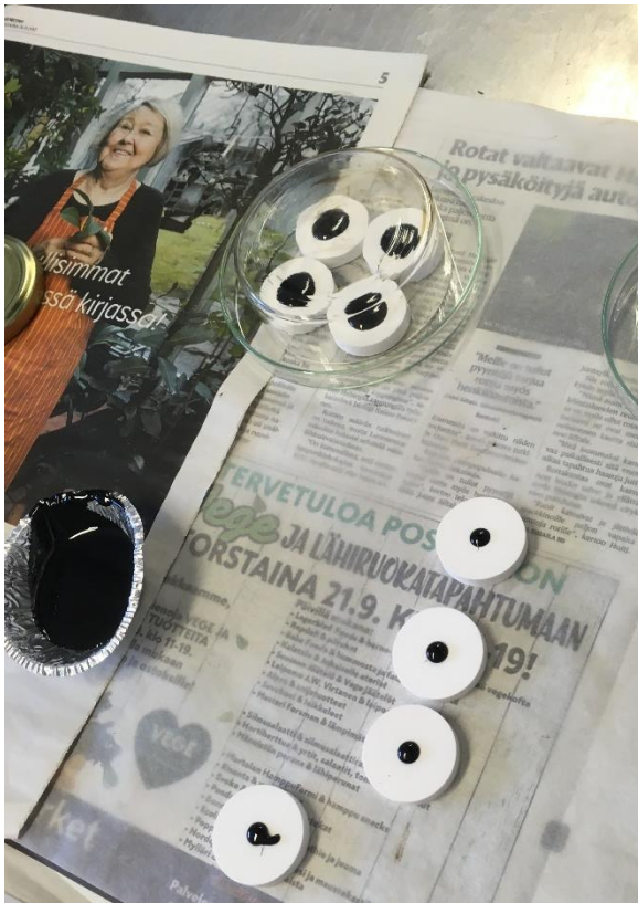
Kuva 3.5 Bitumi kaadettuna 8mm ja 25mm testigeometrioille sopiviin muotteihin
