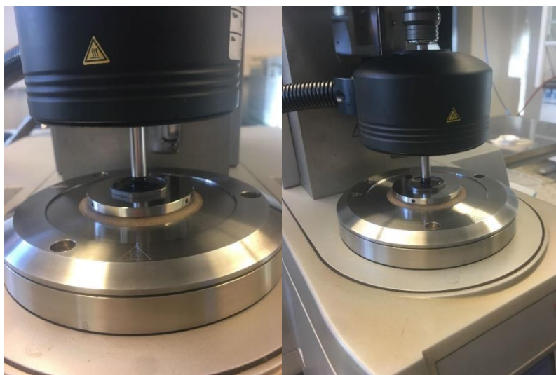
Kuva 2.3. Näytteet asetettuina testauslaitteistoon 8mm ja 25mm testigeometrioihin
