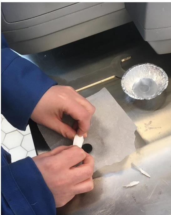
Kuva 3.6. Jääkaapissa viilennetyn näytteen muotista irrottaminen paperille
