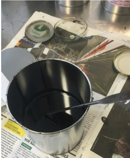
Kuva 3.1. Näyte lämmitetään standardissa määriteltyyn lämpötilaan, sitä hämmennetään ja sen juoksevuus tarkastetaan
