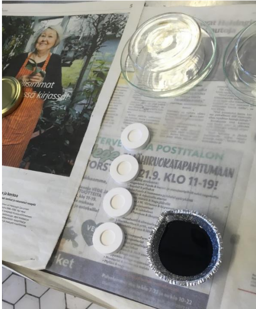
Kuva 3.3 Näyte kuumennetaan uunissa uudelleen ja jaetaan 8mm ja 25mm testigeometrioidelle sopiviin muotteihin
